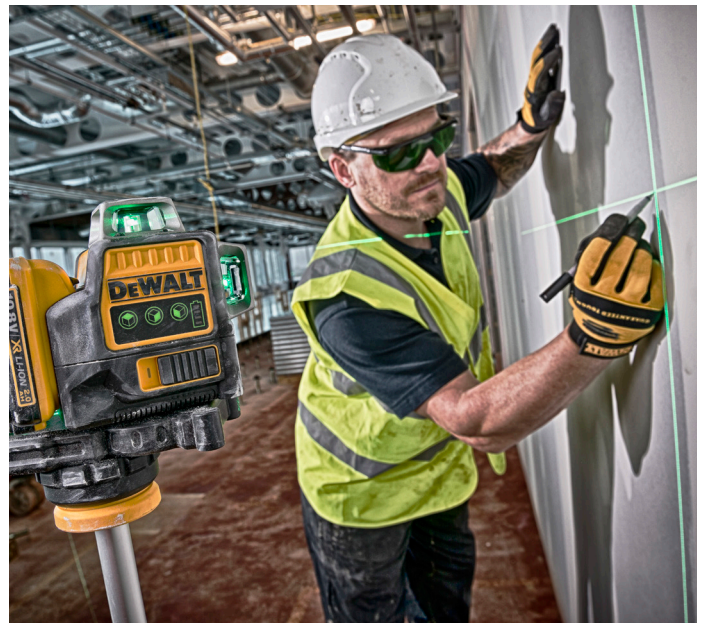
DEWALTs nye krydslinjelasere med grøn laserstråle giver et skarpt og tydeligt grønt kryds. Rækkevidden er hele 30 meter.
