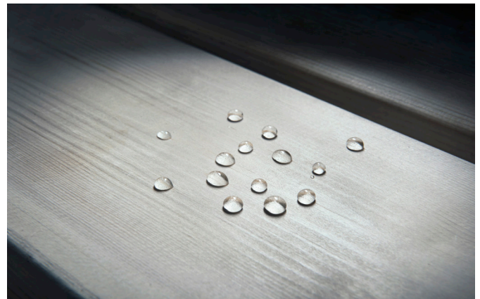
Organowood-käsittely on kaksivaiheinen. Organowood 02 Lika- ja vesisuojoilla lisätään puukuitujen pintaan voimakkaasti vettä hylkiviä molekyylejä, joka saa vesipisarat valumaan pois puun pinnalta.
