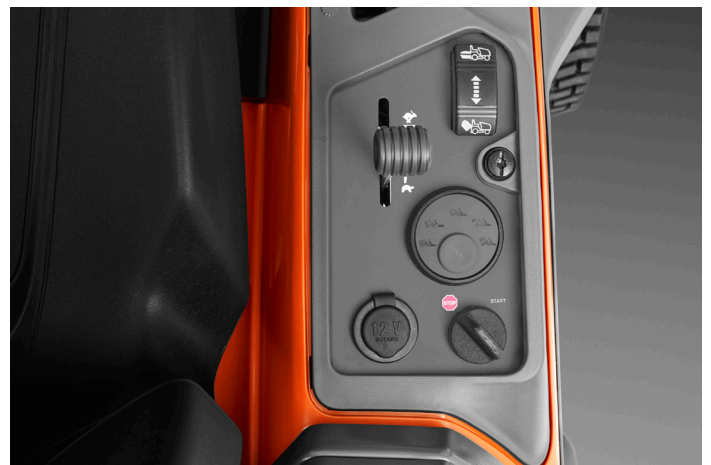
Føreren kan fra føreraset styre hvorvidt gresset skal samles opp eller ikke, samt justere klippehøyden.
