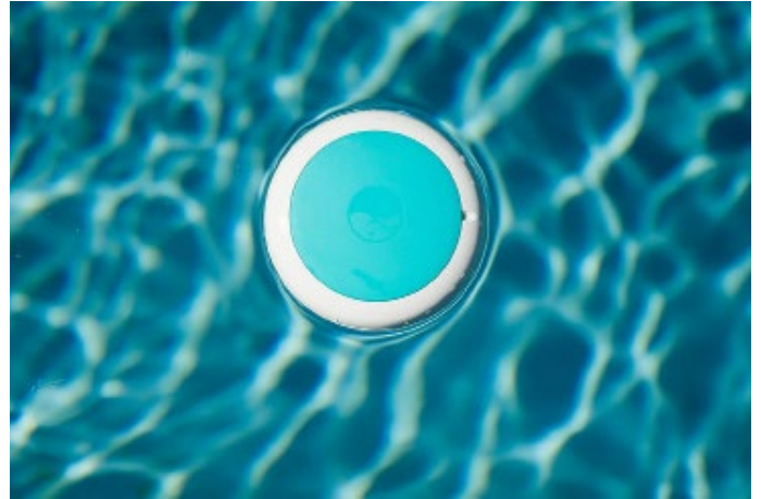
Nyheten ICO mätstation ligger som en liten flytboj och guppar på vattenytan. Den mäter och analyserar vattenkvaliteten varje timme.
