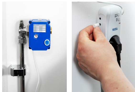
Motorventilen monteras på vattenledningen och bryter vattentillförseln vid läckage.
