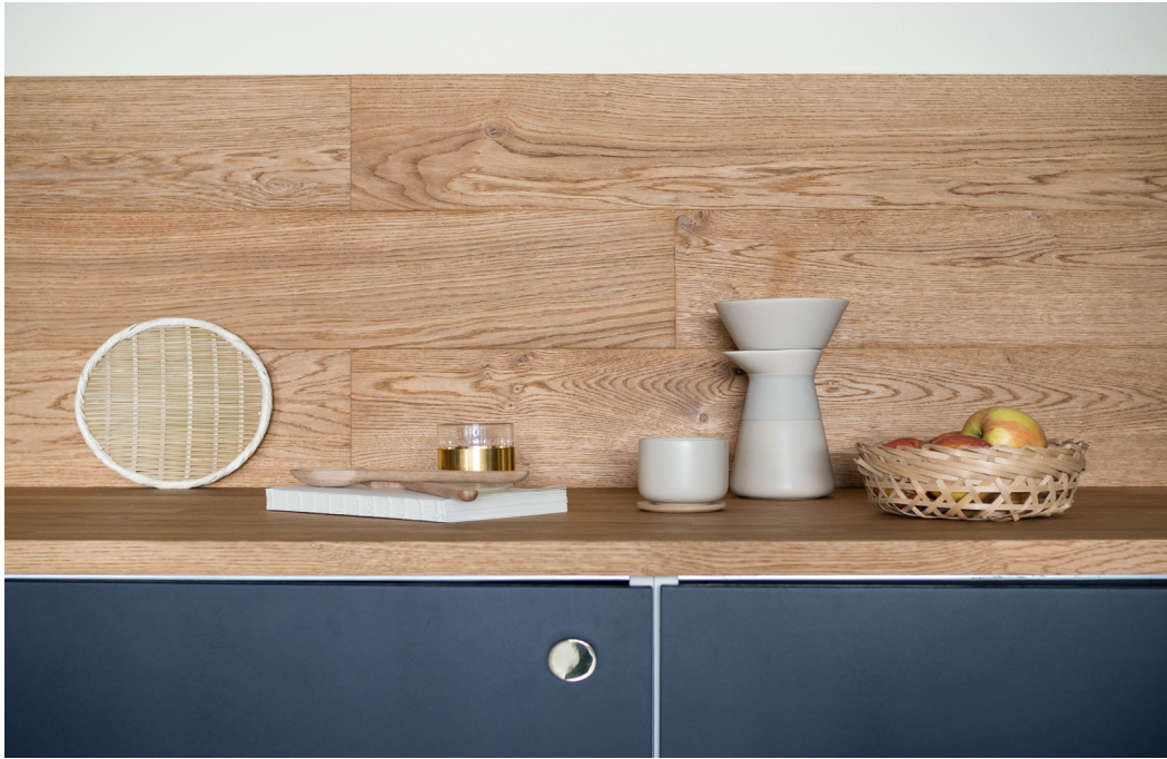
Tammitaso ja seinäverhous ovat käsitelty Värillisellä öljyvahalla nro 3071 Vaalea tammi, joka pehmentää puun luonnollista sävyä. Kaapisto on käsitelty kahteen kertaan Puuvahalla, jonka sävy on itse sekoitettu.
